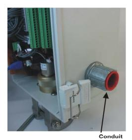
Figure 4. Conduit for Wiring
