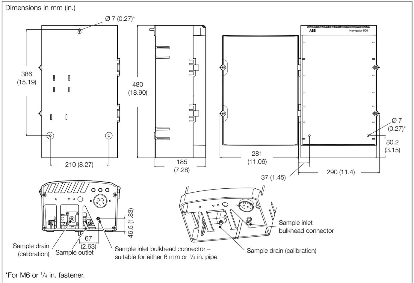
Fig. 3.2 ADS550 wet-section cubicle dimensions
