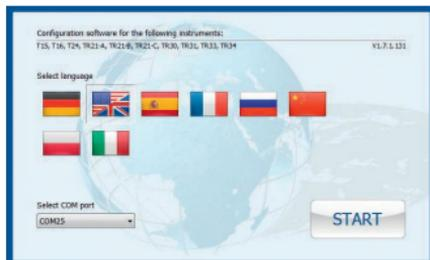
Nach dem Anschluss eines Transmitters (mit PU-548) kann durch Aktivieren des Start-Buttons die Konfigurationsoberfläche geladen werden.
